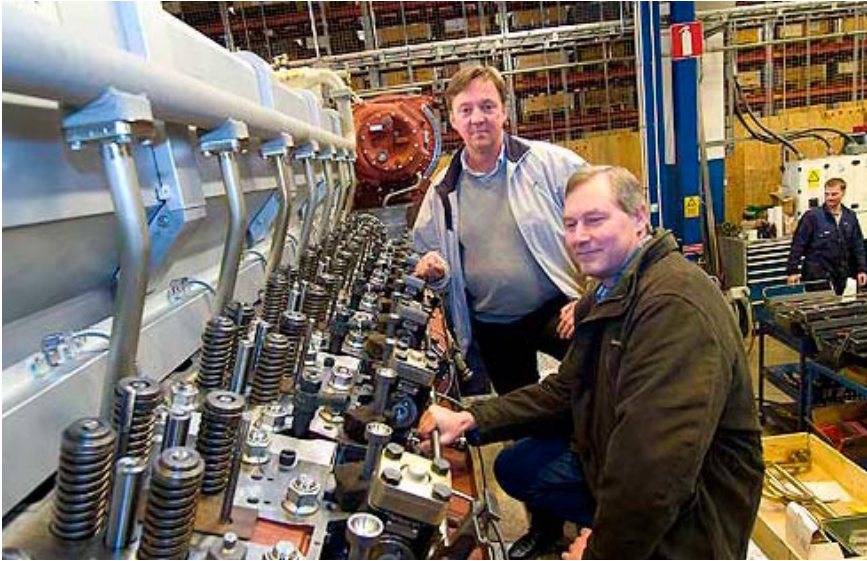
Stefan Söderlund och Lennart Andersson framför en marinmotor under renovering. Med nytt styrsystem och specialutvecklade temperaturgivare blir en renoverad motor från Wärtsilä lika effektiv som en ny tillverkad.
