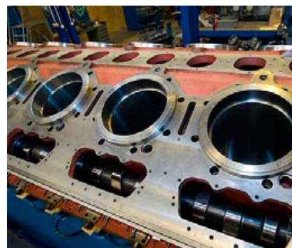
Varje cylinder har lika stor volym som en hel lastbilsmotor. Ändå är det här en liten marin-diesel.
