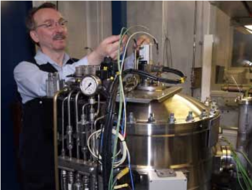
– Temperaturen är direkt förknippad med motorns effekt, berättar Tommy Backheim. Därför har Kockums lagt ned stor omsorg på temperaturmätningen.
