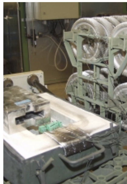
Manteltermoelementen borras in i komponenterna och temperaturen registreras under hela processen. Loggern placeras inuti den inre temperaturbarriären bakom termoelementkontaktarna och överför mätvärdena kontinuerligt via radio.
