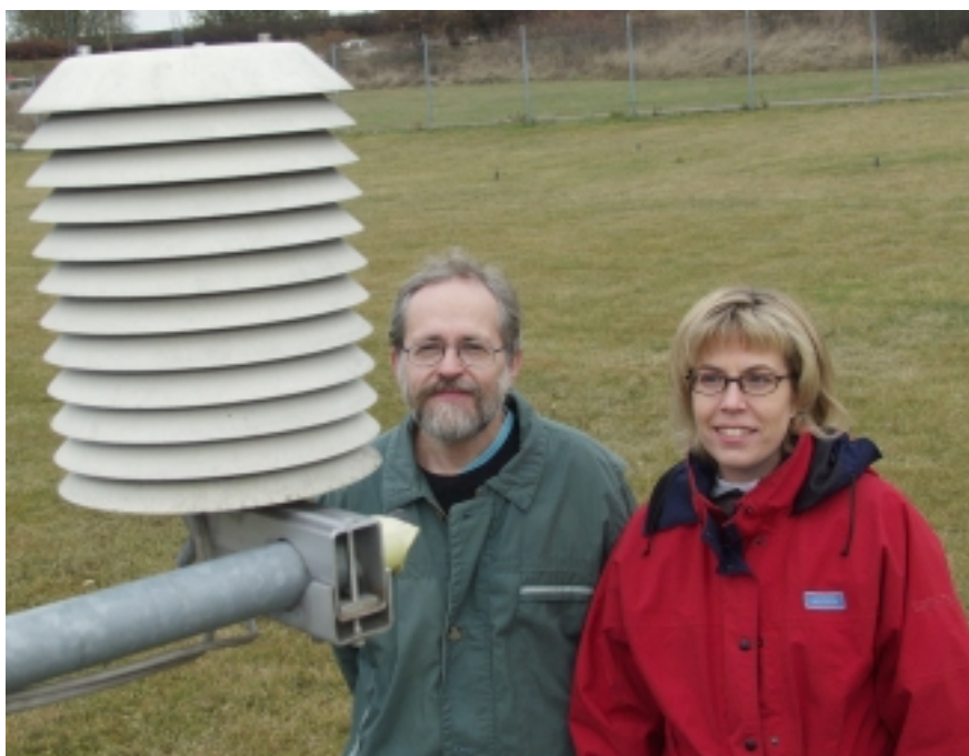
Hans Alexandersson och Ann-Christine Andersson är två av dem som ger oss vårt dagliga väder och studerar den globala uppvärmningen. Innanför skalet döljer sig en kalibrerad Pt 100-givare, som numera är stommen i SMHI:s temperaturmätningar.
